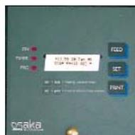
Impresora de temperatura y tiempo con impresión numérica sobre papel continuo con intervalos de impresión seleccionables desde 1' hasta 99 horas.
