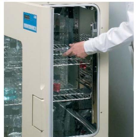
La óptima homogeneización de la temperatura se consigue con una razonable distribución del espacio y carga, no sobrepasando el 70% del volumen útil.
