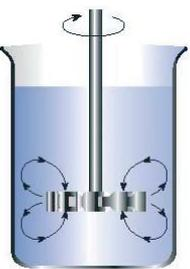
**Flujo Radial**, incidencia gráfica de agitación en el medio. Agrupa los rotores cuyas aspas están en paralelo con el eje de agitación. (Rotores tipo turbina radial).
