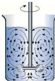
**Flujo Radial Dinámico**, incidencia gráfica del principio cónico en el medio de agitación. Agrupa toda la serie de rotores Visco-Jet®. Excelentes resultados y de mínimo consumo.
