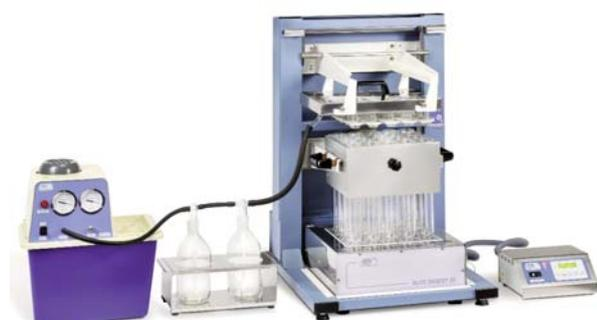
Bomba de recirculación "Scrubber" Bloque digestor
