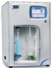
Destilador Kjeldahl semi automático "Pro-Nitro S"
